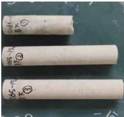
杭周固定部コア
